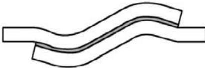
شكل 5. وصلة لاصقة حاضنة متموجة الشكل
